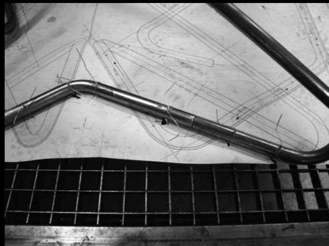
stolen fikses på det eneste vandrette rør inden samling
